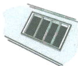
Châssis type « tabatière »
